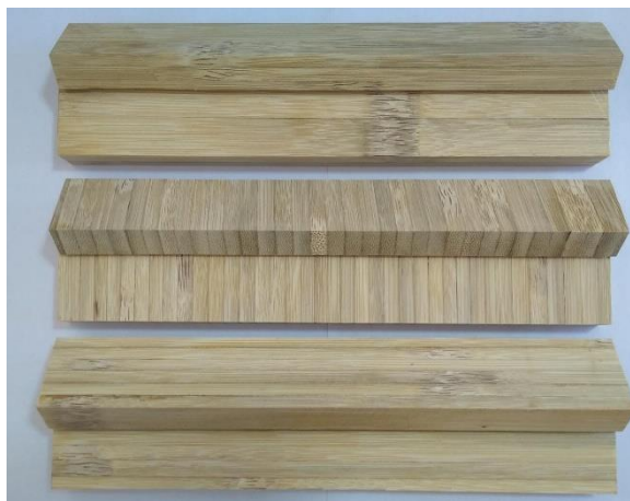
Figura 1. Probetas laminadas de bambú.
